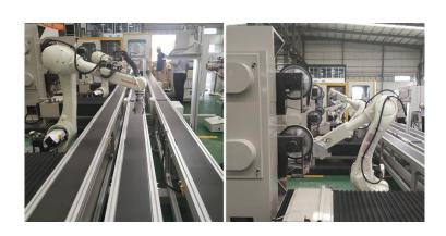
川崎机器人&佛山隆深机器人为知名 500 强家电企业打造的电熨斗底板打磨抛光自动化生产线, 完全实现了转产无人干预的壁垒突破、混线生产的壁垒突破、兼容性可持续扩大这三项技术升级, 促进企业生产自动化可持续升级至无人化。
